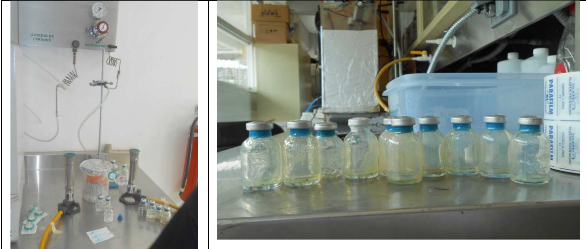
Figura 1 - A la izquierda sistema de distribución de los gases, a la derecha, frascos de roll tube
