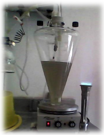
Figura 2. Matras de widell. El matraz de Widdel (Widdel, 1990) es frecuentemente utilizado para preparar medios de cultivo estériles con una atmósfera controlada. Su diseño permite una atmósfera sin oxígeno, mayor que la se obtendría en una simple desgasificación por sistema de inyección
