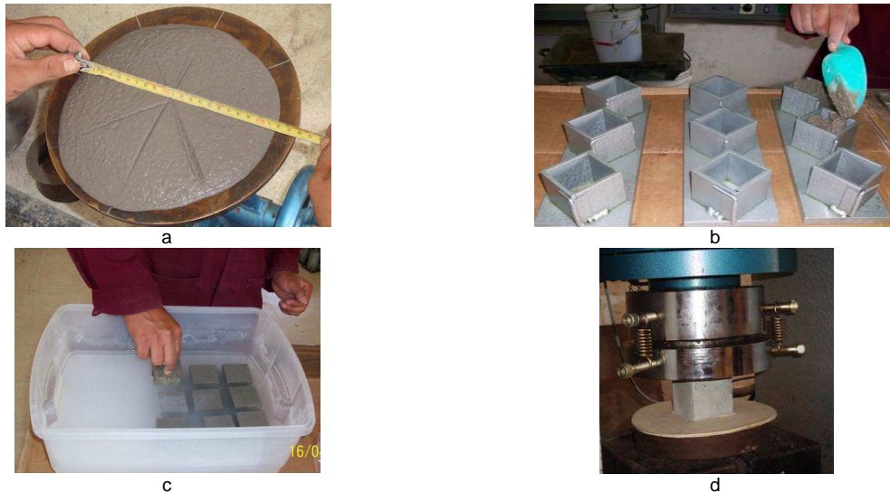
Figura 3.- Procedimiento para determinar el IAR, a) evaluación de la fluidez de la mezcla, c) colado de cubos de mortero, curado y d) ensaye de resistencia a compresión
