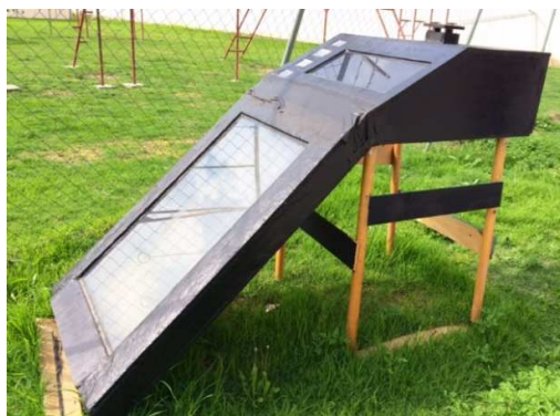
Figura 5. Secador solar instalado.
