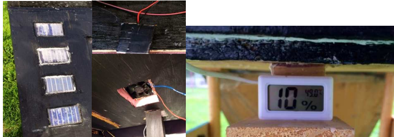
Figura 4. Componentes para el ventilador impulsado por celdas solares y higrómetro.
