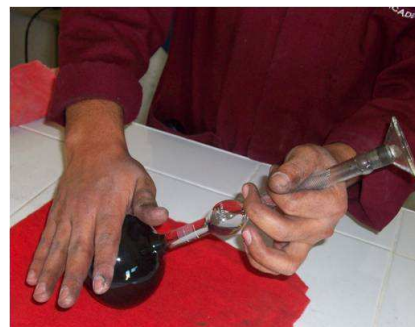
Figura 2.- Determinación de la densidad de la CBC, a) adición de la ceniza en nafta, b) expulsión de aire
