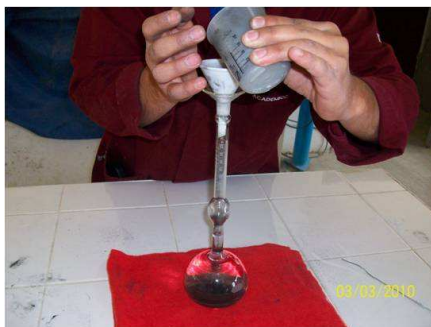
Figura 2.- Determinación de la densidad de la CBC, a) adición de la ceniza en nafta, b) expulsión de aire
