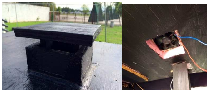
Figura 3. Chimenea y ventilador del secador solar.
