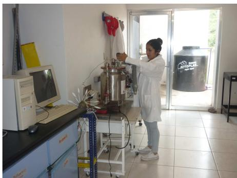
Figura 4.1: Biodigestor escala laboratorio con almacén, sensor de metano y software de adquisición de datos.
