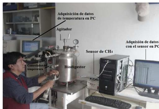
Figura 4.2: Sistema experimental de biodigestión y software de adquisición de datos.
